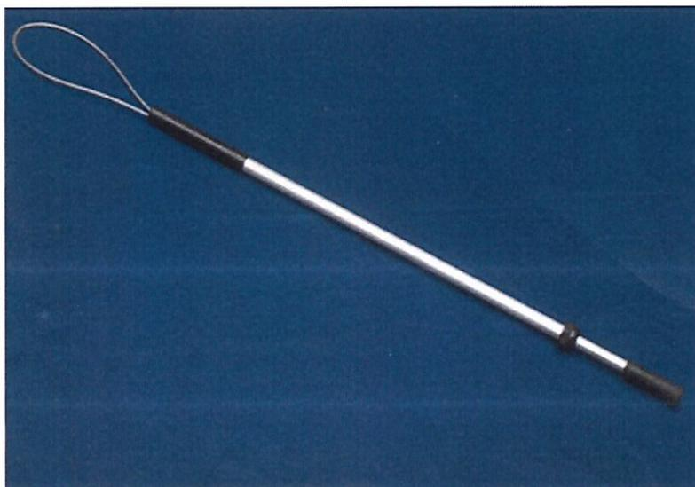
Figura 2 – Esse cambão é composto por uma haste telescópica de alumínio que pode ser travada por uma borboleta, e um laço de cabo aço revestido em polietileno que reduz sua circunferência à medida que a haste é alongada, permitindo um ajuste preciso ao diâmetro do pescoço do animal que estiver sendo manejado. Fonte: ® Igapó Captura e Manejo
