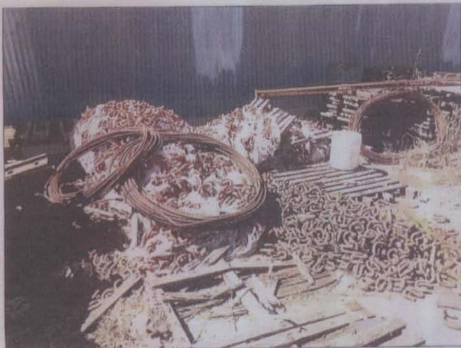
Foto 04 – Grampos elásticos armazenados sem cuidados no Pátio de Uruaçu.
