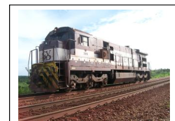
Locomotivas GE C36-7 da Ferrovia de Carajás. Bitola: 1,60 m Potência Instalada: 3.950 HP
