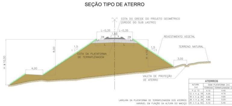
Figura 1: Seção Transversal Tipo de Aterro.
