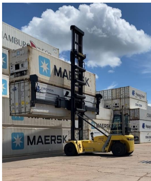
Figura 9 – Exemplo de empilhadeira de vazios em operação.
