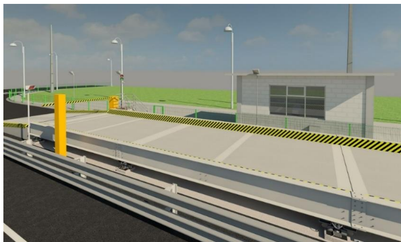
Figura 6 – Modelo exemplificativo de Balança para o Gate.
