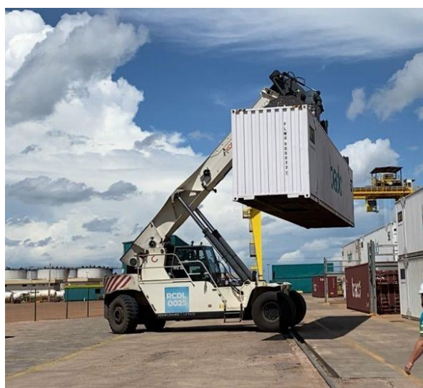
Figura 8 – Exemplo de Reach Stacker em operação.
