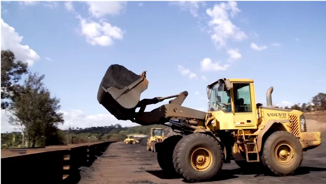
Figura 7 - Expedição de Minério utilizando Muro de Carregamento (Fonte: MRS Logística 1 )
