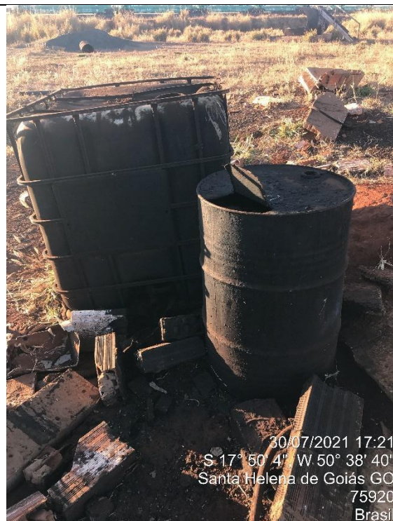
Figura 14. Tanques de óleos que transbordaram com as precipitações. Fonte: Autor
