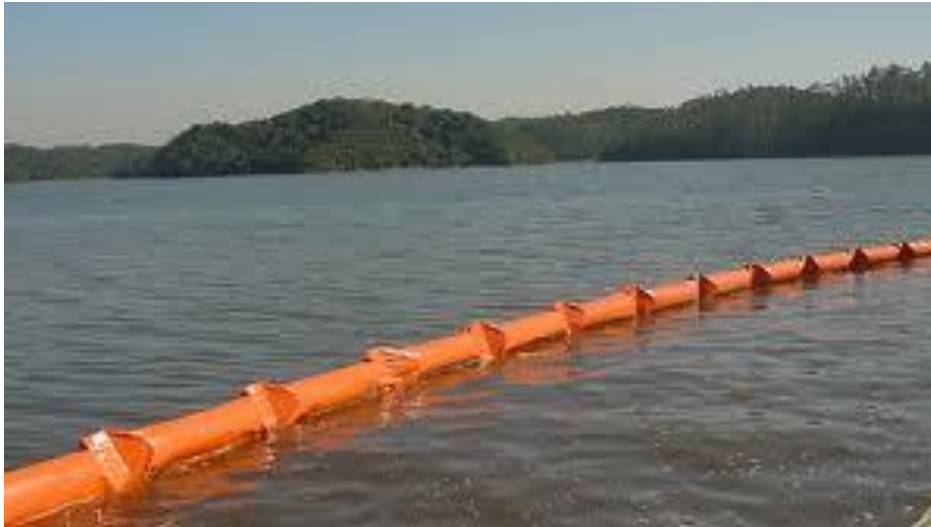
Figura 1 - Modelo de barreira retentora de óleo
