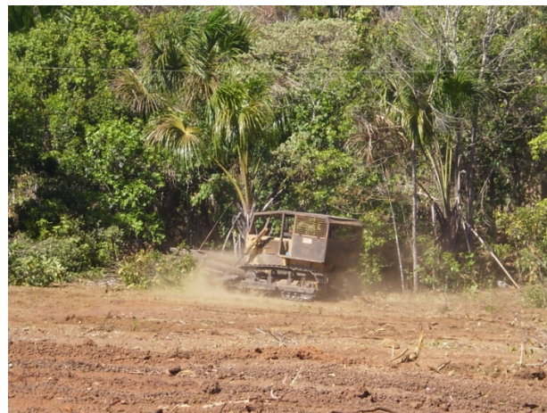
Figura 3.4.1. Utilização do trator de esteira (D6) para supressão da vegetação em empreendimentos ferroviários (Fonte: OIKOS)
