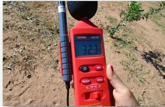
Figura 26: Medidor do nível de pressão sonora
