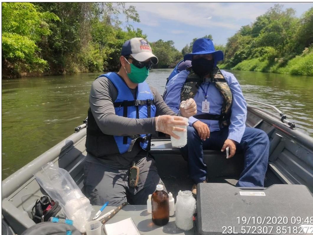
Foto 094 – Coleta para análise dos parâmetros físico-químico da água.
