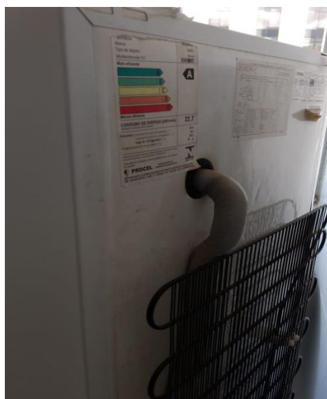
Figura 29: Refrigerador com a tabela de consumo/eficiência do INMETRO, indicando a Classe A.
