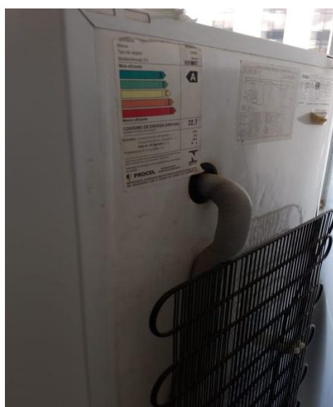
Figura 18: Refrigerador com a tabela de consumo/eficiência do INMETRO, indicando a Classe A.
