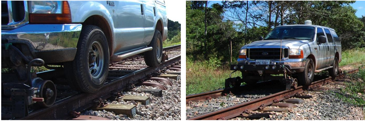
Figura 23 - Veículos adaptados para se deslocar sobre os trilhos
